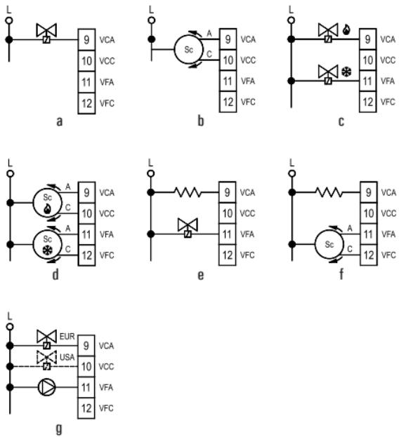
**Fig. 8:** Possibles variantes pour connexionvannes
